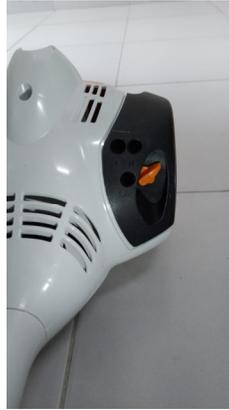
4. Colocar la maquina sobre el suelo, debe quedar firmemente apoyado en el soporte del motor y el deflector
