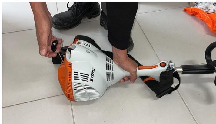
6. Tan pronto arranque el motor oprima el bloqueo y tire del gatillo de aceleración. La perilla del estrangulador se mueve automáticamente a la posición de marcha I. Después de arrancar un motor en frío, caliéntelo por medio de abrir el acelerador varias veces.
