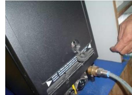
Pulse firmemente el botón hasta sentir la activación del botón. Al terminar la actividad y comprobar que la máquina está operando vuelva a cerrar la tapa girando ahora en sentido contrario. Una vez terminado este procedimiento esperar 20 minutos para que el agua alcance su temperatura
