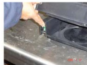
En la tapa posterior plástica de la máquina encontrará un círculo atravesado por una ranura como se señala, este círculo es la tapa protectora de un botón. NO intentar quitar los tapones ubicados en la parte baja metálica (Ubicados entre conector de agua y cable)
