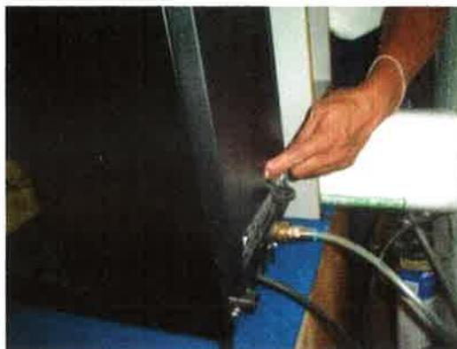
*Pulse firmemente el botón hasta sentir la activación del botón. Al terminar la actividad y comprobar que la máquina está operando vuelva a cerrar la tapa girando ahora en sentido contrario. Una vez terminado este procedimiento esperar 20 minutos para que el agua alcance su temperatura*
